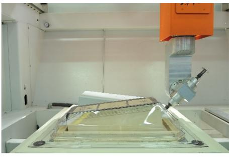
Die Protective Boxen werden auf modernsten Maschinen durch Thermoformen eigens bei BAVARIA aus den Materialien ABS und Polycarbonat produziert und weltweit vertrieben. Die Schutzboxen passen sich dank ihres schlichten und modernen Designs in die Umgebung ein, sodass der Feuerlöscher geschützt aber doch sichtbar ist. Ein Panikverschluss gewährleistet die schnelle Entnahme des Feuerlöschers, dennoch ist
